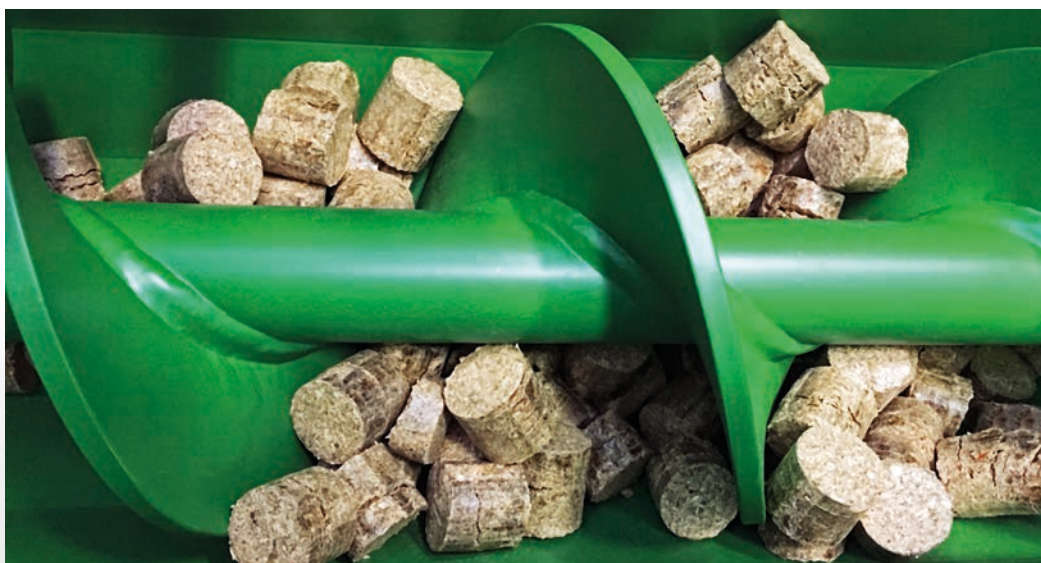
Transportador de tornillo con briquetas de la prensa Briklet
